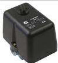
**Реле давления Condor MDR** предназначено для автоматизации работы компрессора, включая его при понижении давления в системе ниже установленного предела и отключая при достижении верхнего установленного предела давления. Следствием использования такого реле является увеличение срока эксплуатации компрессора, а также снижение потребления электроэнергии.
