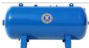
На базе компрессора размещены **два горизонтальных воздушных ресивера объемом 150 литров каждый**. Бежецкий завод "АСО" более 80 лет производит воздухохранилища разного объема (от 10 до 900 литров) для сжатого воздуха давлением до 25 атм. Ресиверы окрашиваются на автоматической итальянской линии порошковой окраски.
